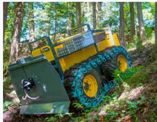
Abb.1: Raupenseilwinde der Firma Martin Alther, Land und Forstmaschinen AG
